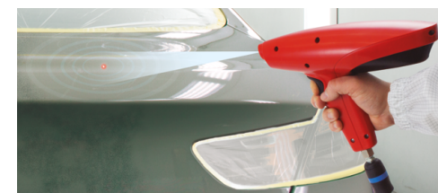
4. Premere il grilletto. Il laser indica l'area che stiamo decontaminando e ionizzando.
