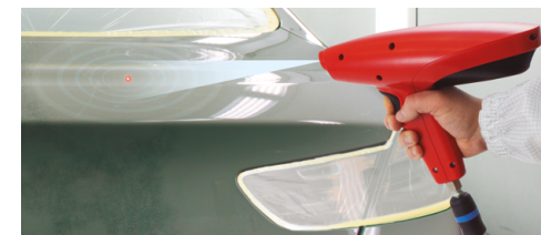
4. Appuyer sur la gâchette. Le laser indique la zone que nous décontaminons et ionisons.
