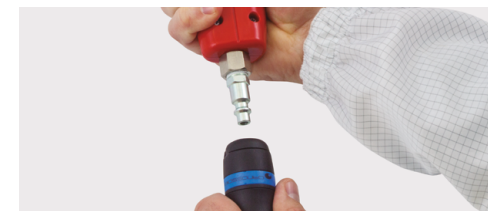
3. Una volta caricato la pistola, scollegare dal caricabatterie e collegarsi alla linea dell'aria.
